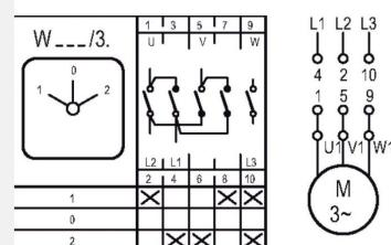
Performants, robustes et compacts, les commutateurs à came sous coffret sont mis en oeuvre dans les milieux tertiaires et industriels. L'offre comprend différentes versions permettant de réaliser une simple inversion de source (I-0-II) jusqu'à de la commande moteur complexe (Dalhander, étoile-triangle, inverseur de sens de marche,...).
