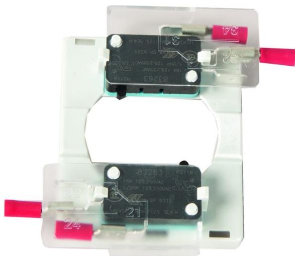
Contacts auxiliaires de signalisation ou de commande 20 + 2F pour interrupteur-sectionneur sous coffret O2 de 16 à 80A. En fermeture, il commute après les contacts principaux. En ouverture, il commute avant les contacts principaux.
