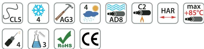
**Données techniques****Âme :** cuivre nu souple, classe 5**Isolation :** EPR qualité EI4**Gaine externe :** mélange spécial de caoutchouc polychloroprène type EM2, noir RAL 9005**Tension de service Uo/U :** 450 / 750 V AC
