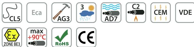
**Données techniques****Âme :** cuivre nu souple, classe 5**Isolation :** polyéthylène réticulé (XLPE)**Câblage des conducteurs :** couches concentriques**Assemblage :** ruban polyester**Blindage général :** tresse en cuivre étamé
