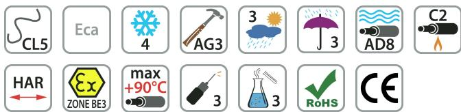
**Données techniques****Âme :** cuivre nu souple, classe 5**Isolation :** élastomère spécial réticulé (El4)**Câblage des conducteurs :** couches concentriques**Gaine externe :** polychloroprène ou autre élastomère réticulé synthétique similaire**Tension de service Uo/U :** 450 / 750 V AC
