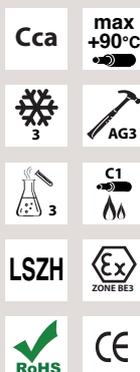
**NF C 32-323** : câbles rigides de tension assignée  $U_0/U$  au plus égale à 0,6/1 kV sans halogène à comportement au feu amélioré C1, à isolation synthétique réticulée et gaine de protection synthétique extrudée.
