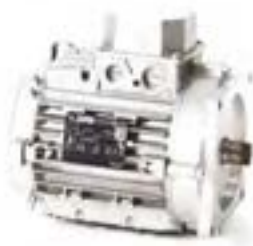
Moteur application hydraulique, couplage direct entre le moteur et l'unité de commande à l'aide de brides carrées spéciales et d'arbres de tirage
