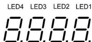
Figure 3.1-1 Écran LED à 7 segments
