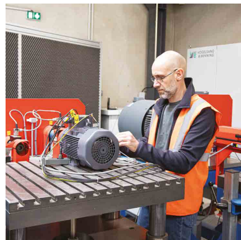
Contrôle qualité et performance sur notre banc d'essai de moteurs en charge.
