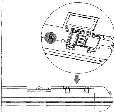
Possibilité de connexion de l'alimentation au dessus du luminaire en passant par la trappe (connecteur Push facile).
