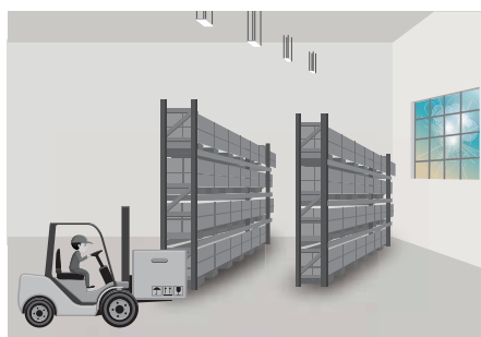
En cas d'apport de lumière naturelle suffisant, l'éclairage reste éteint.
