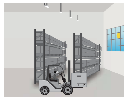
Le niveau d'éclairage est ajusté automatiquement en fonction de l'apport de lumière naturelle.
