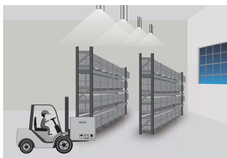
Lorsque la lumière naturelle est en-dessous de la valeur déterminée, l'éclairage s'allume en cas de détection.
